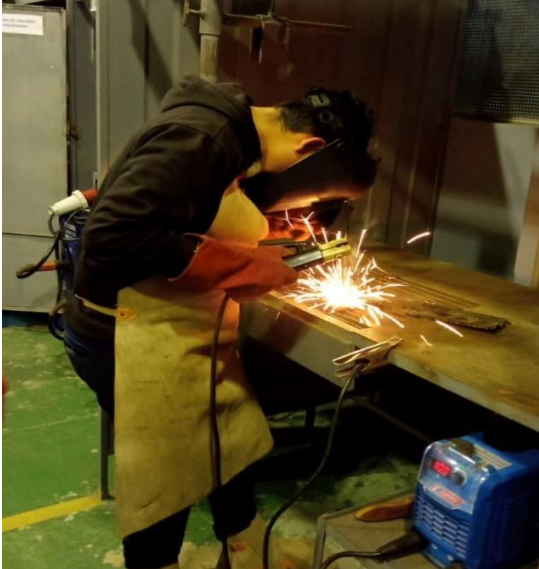
Fig. 9.1. Soldadura en posición 1G.
