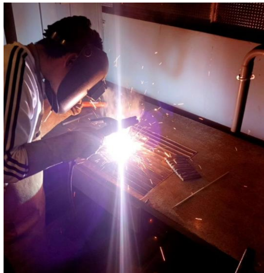
Fig. 9.4. Soldadura en posición 1G.
